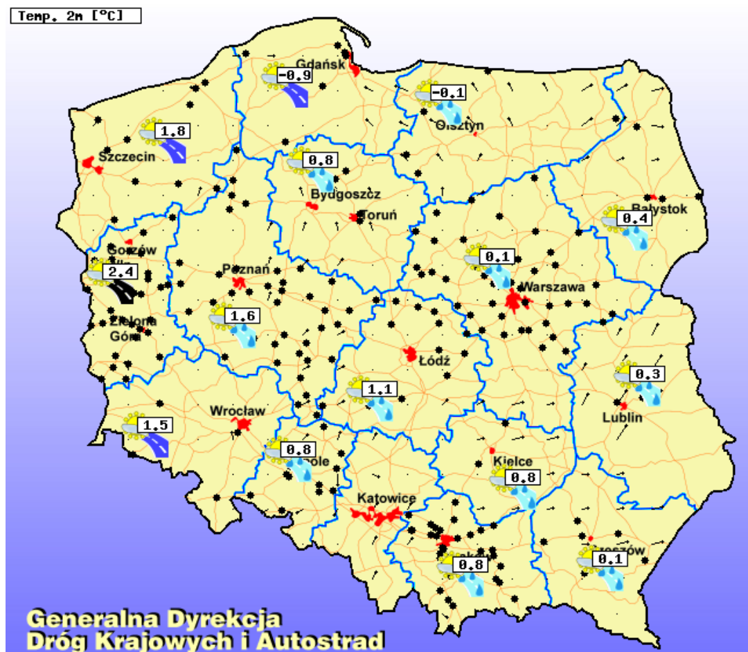
Rys. 5. Informacja o aktualnym stanie pogody pochodząca z przydrożnych automatycznych stacji meteorologicznych ( http://www.traxelektronik.pl/pogoda/drogi/index.php ).
