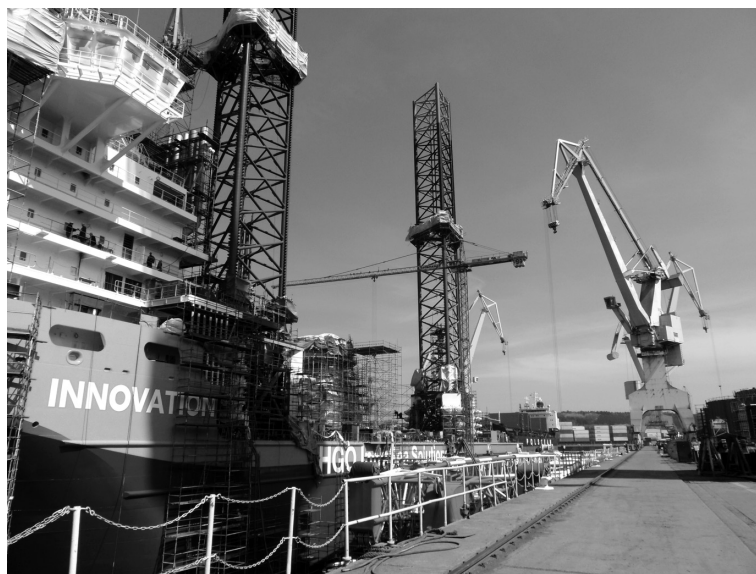
Fot. 1. Jednostka do stawiania wież farm wiatrowych na morzu Innovation w stoczni Crist fot. Marek Grzybowski, 2012.
